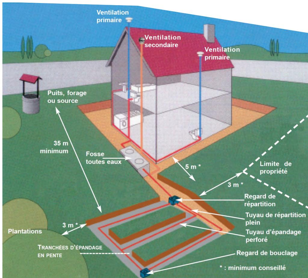
**Pour une pente comprise entre 5 et 10 %, la technique des tranchées d'épandage à faible profondeur est utilisable en disposant les tranchées perpendiculairement à la pente.**
