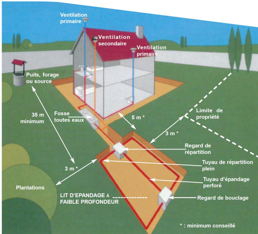
Cette filière d'assainissement autonome est utilisée dans le cas où la réalisation des tranchées d'infiltration est difficile en raison d'une faible tenue mécanique (ex : sols sableux).
